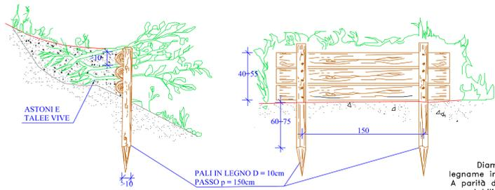
Diametro del legname indicativo. A parità di effetto stabilizzante è possibile utilizzare legname con diametro superiore
