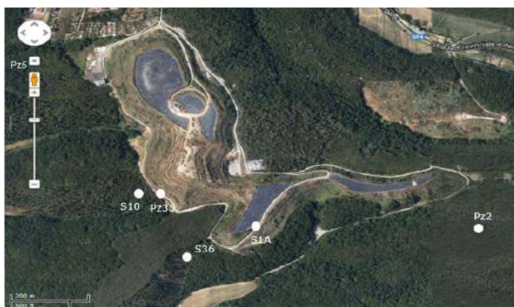
Figura 18 - Dislocazione piezometri area “Discarica”
